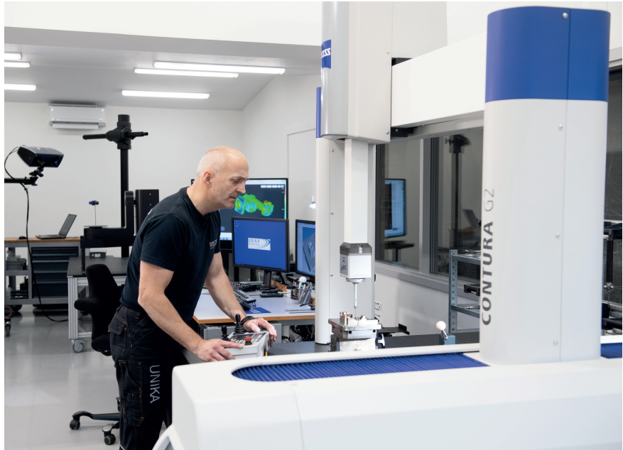
Mit dem Koordinatenmessgerät Contura G2 vermisst Frank Fynbo die Spritzgießwerkzeuge.
